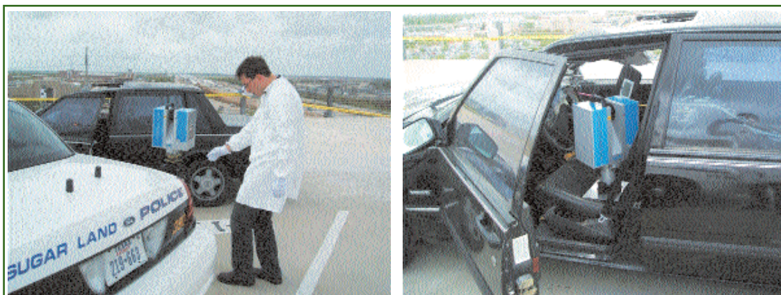
Рис. 2 Измерения с помощью IMAGER 5006 при ДТП
