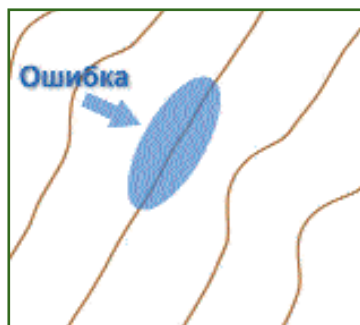
Рис. 4 Пример неправильной укладки горизонталей
