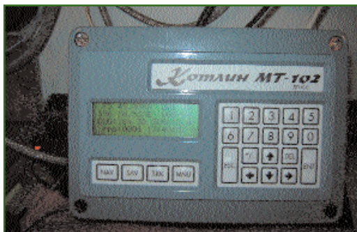
Рис. 3 Спутниковый навигационный приемник ГЛОНАСС/GPS «Котлин» МТ-102
